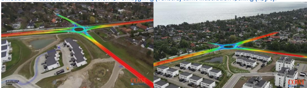
Billede 3 – Hastighedskort udarbejdet ved brug af videoanalysesoftware af rundkørslen før (venstre) og efter ombygning (højre).
